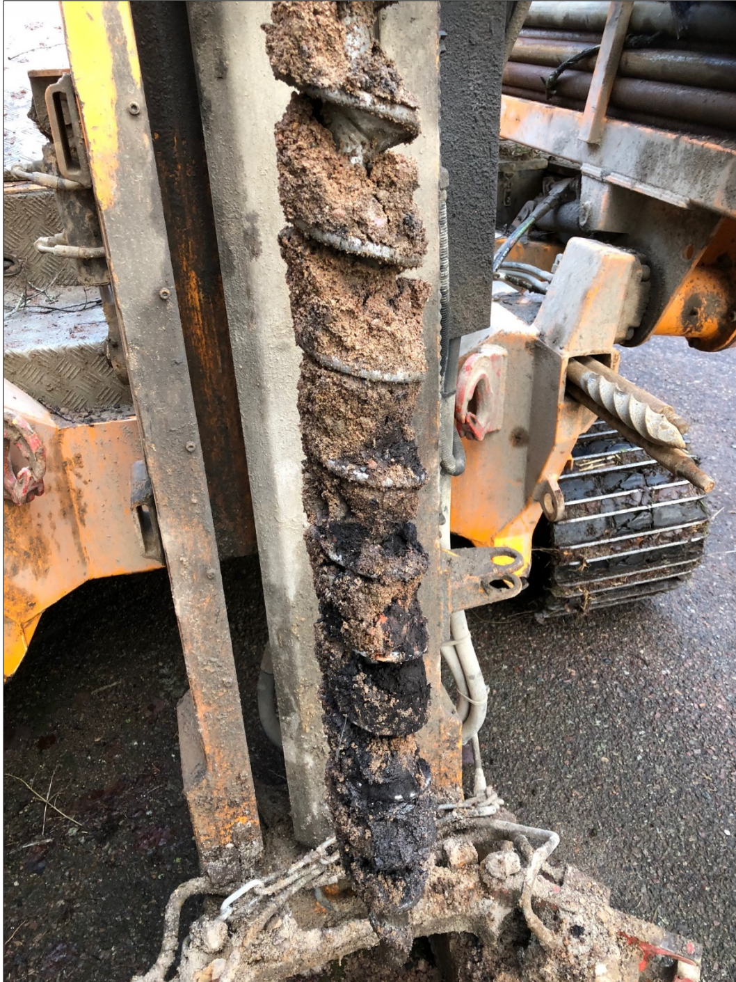
Foto 1 Borrskruv från 0-1 meter vid SK18J04 (oljelukt)
