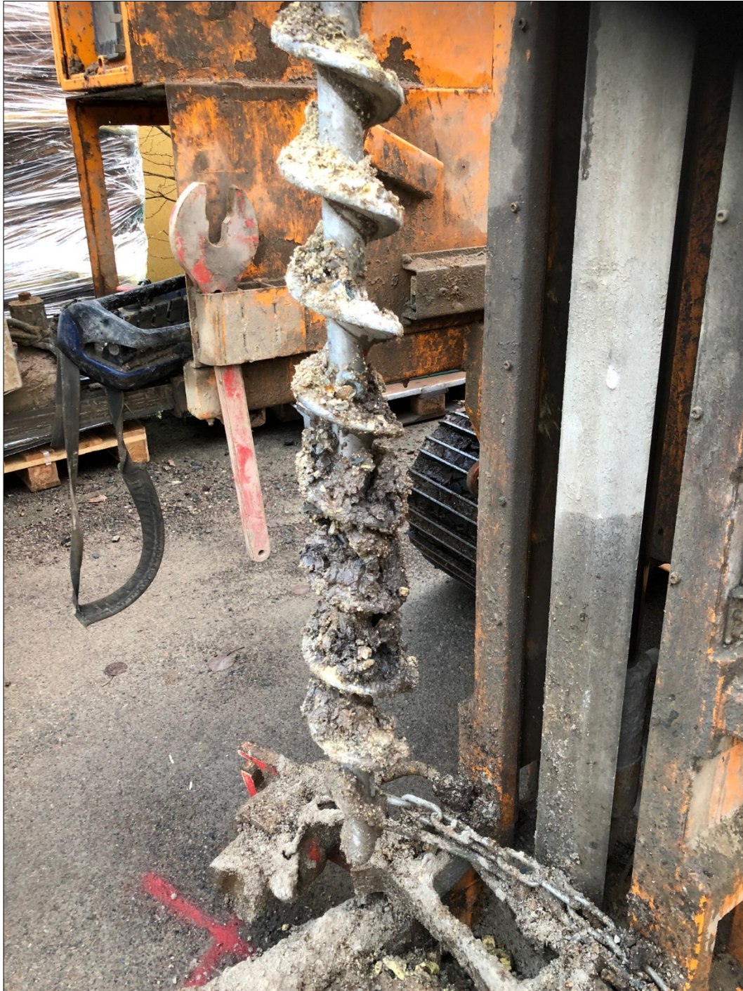
Foto 2 Borrskruv från 0-1 meter vid SK18J05 (glaskross)
